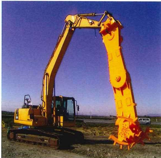
ブームランププレート装着でN値38の礫混じり砂層に対応
