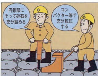
4. 間詰砕石の充填・締固め
