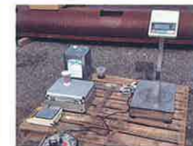
固化材・水 量計器機器
