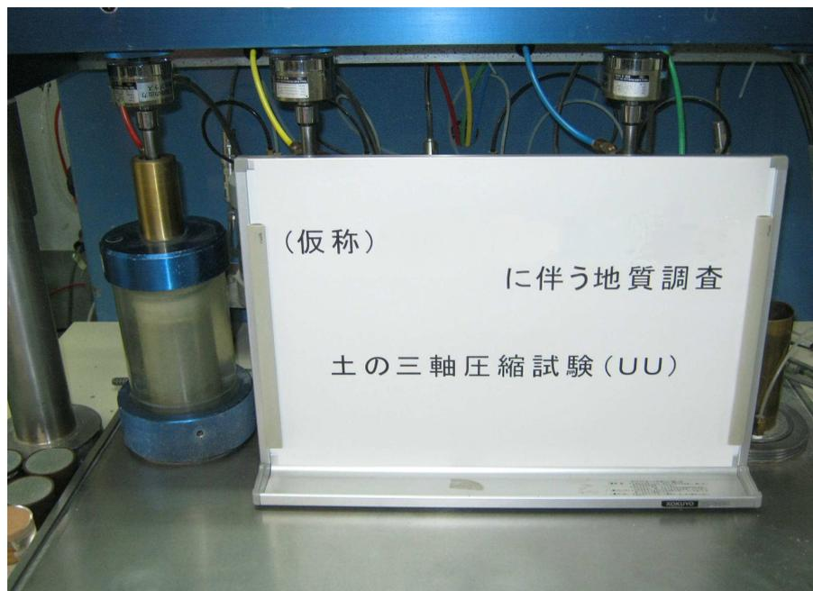
土の三軸圧縮試験(UU)
